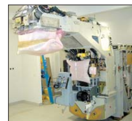
Beinahe raumfüllend ist der auf diesem Foto noch nicht endgültig installierte, neue Linearbeschleuniger.
